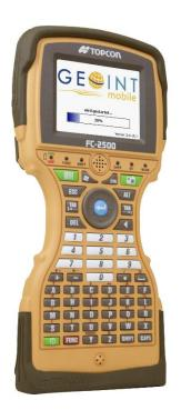
Der FC-2500 wird von Topcon zur Steuerung von Topcon GNSS- und Tachymetersystemen gefertigt.
