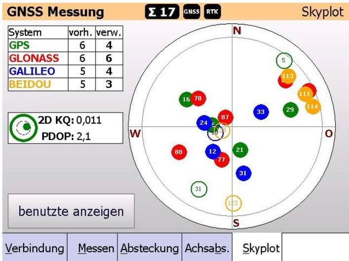
In dem Beispiel links empfängt die GNSS Antenne insgesamt 22 Satelliten (6+6+5+5) in allen Satellitensystemen.
