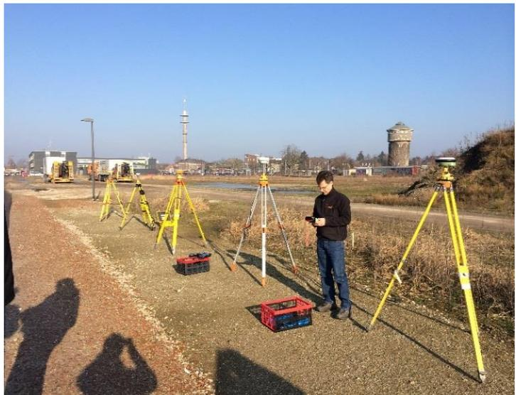
Nach einer Minute erfolgte eine weitere 15-Epochen **Messung** mit demselben Fixing. Die Verbindung zum RTK Dienst und dem Internet wurde anschließend getrennt.
